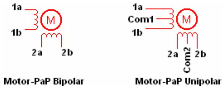
Espero que hayas notado la diferencia, bueno, es que mientras los Unipolares disponen de dos bobinas independientes los Bipolares parecieran tener 4 debido al terminal central que es el común de cada par de bobinas, pues a eso se debe aquello de los 6 cables y que si unes los terminales Com1 y Com2 tienes un terminal común y 4 terminales de control (es decir 5 cables). Bien, ahora veamos como controlar estos motores...
